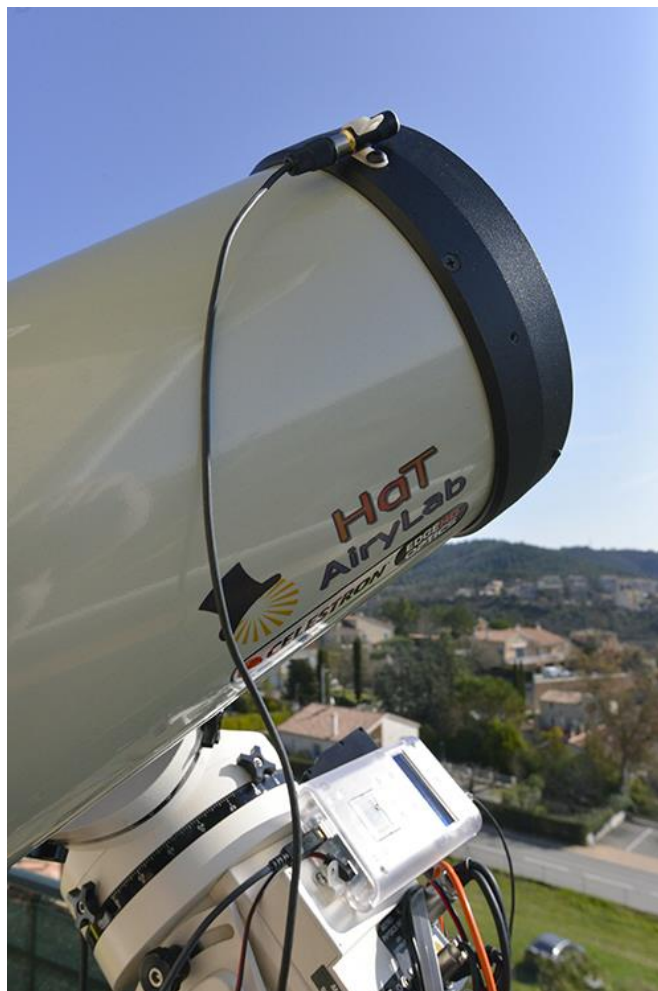
Capteur du SSM fixé sur un télescope HaT
